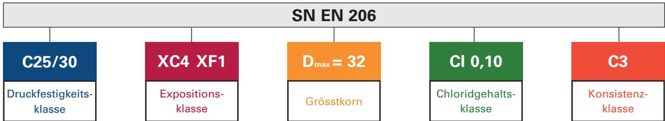
**Druckfestigkeitsklassen.** Sie bezieht sich auf die charakteristische Mindestdruckfestigkeit von Betonzylindern (1. Zahl) und Betonwürfeln (2. Zahl). In der Schweiz wird die charakteristische Druckfestigkeit in der Regel an Würfeln mit einer Kantenlänge von 150 mm bestimmt.
